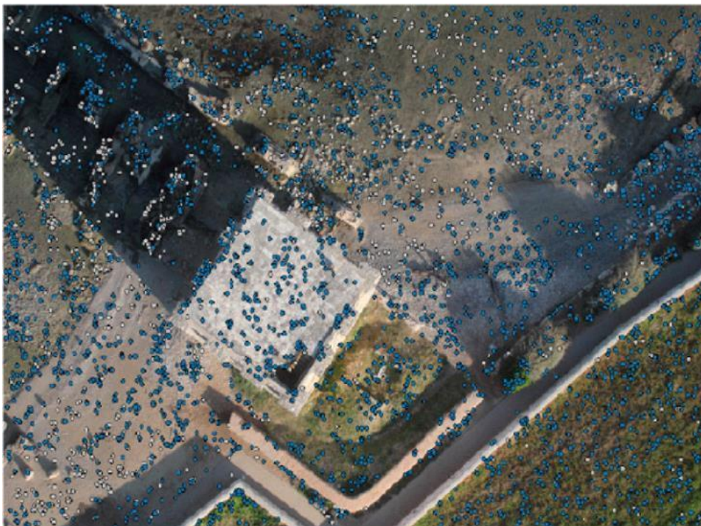
Figura 11 - I descrittori trovati sono i pallini blu e bianchi
